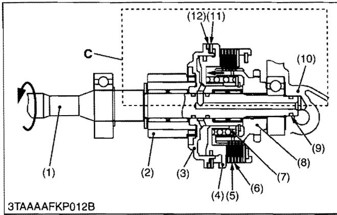
■ PTO Clutch “Disengaged”
